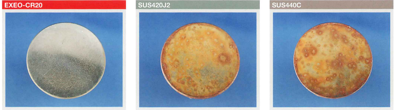
EXEO-CR20、SUS420J2、SUS440C：焼入れ1020℃+サブゼロ+焼戻し490℃×2回。
